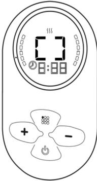
7. L'écran clignote 5 fois 00 et l'appareil se met à chauffer automatiquement. L'écran affiche un rectangle circulaire pendant la chauffe rapide.
