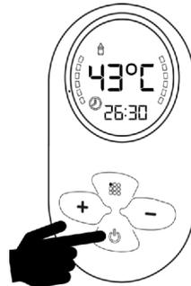
8. Appuyez sur le bouton Marche/Arrêt pour arrêter l'appareil quand la température du lait atteint la température désirée.
