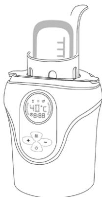
2. Placez le panier repose biberon à l'intérieur de l'appareil, placez l'anneau d'adaptation sur le panier repose biberon et placez le panier petit pot (si besoin) dans le panier repose biberon.
