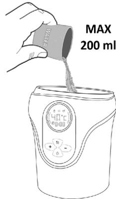
1. ضَع قاعدة الجهاز على سطح ثابت وأقفي ومستوي. باستخدام كوب قياس (غير مرفق)، املا خزان المياه بـ 200 مل من الماء المقطر أو المنقى.
