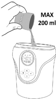
1. Placez la base de l'appareil sur une surface stable, horizontale et plane. A l'aide d'un gobelet doseur (non fourni), remplissez le réservoir d'eau avec 200 ml d'eau distillée ou purifiée.
