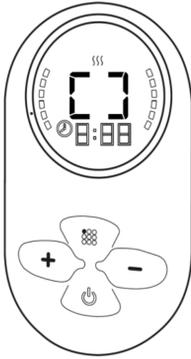
7. L'écran clignote 5 fois 00 et l'appareil se met à chauffer automatiquement à 100°C. L'écran affiche un rectangle circulaire pendant la chauffe rapide.
