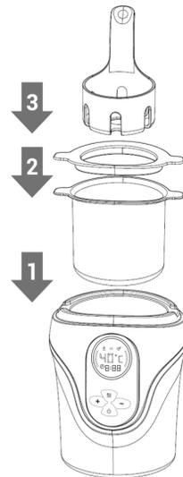
2. Placez le panier repose biberon à l'intérieur de l'appareil, placez l'anneau d'adaptation sur le panier repose biberon et placez le panier petit pot (si besoin) dans le panier repose biberon.
