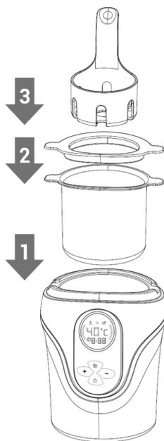
2. Placez le panier repose biberon à l'intérieur de l'appareil, placez l'anneau d'adaptation sur le panier repose biberon et placez le panier petit pot (si besoin) dans le panier repose biberon.
