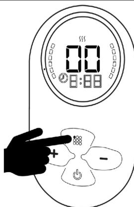
6. Appuyez sur le bouton sélection de fonction, et sélectionnez la fonction chauffe rapide. L'écran affiche l'icône chauffe rapide et 00 (température réglée par défauts).
