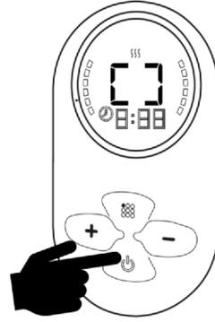
8. Appuyez sur le bouton Marche/Arrêt pour arrêter l'appareil à tout moment. Si vous n'appuyez pas sur le bouton Marche/Arrêt, l'appareil continue de chauffer jusqu'à ce que le réservoir d'eau soit vide puis s'arrête automatiquement en émettant 3 bips sonores.
