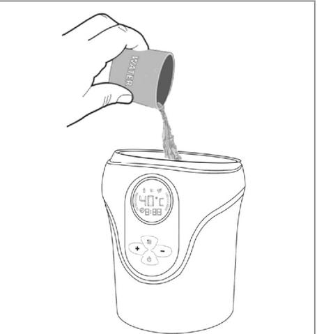
1. ضَع قاعدة الجهاز على سطح ثابت وأفقي ومستوي. باستخدام كوب قياس (غير مرفق)، املا خزان المياه بـ 200 مل من الماء المقطر أو المنقى.
