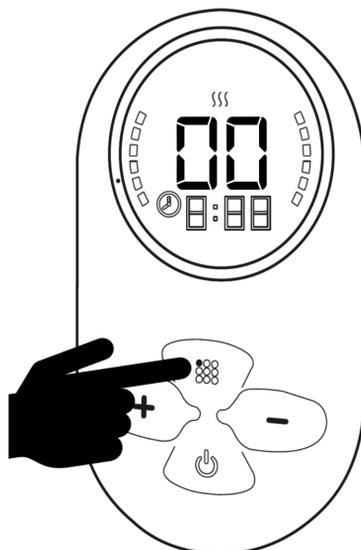
6. Appuyez sur le bouton sélection de fonction, et sélectionnez la fonction chauffe rapide. L'écran affiche l'icône chauffe rapide et 00 (température réglée par défauts).
