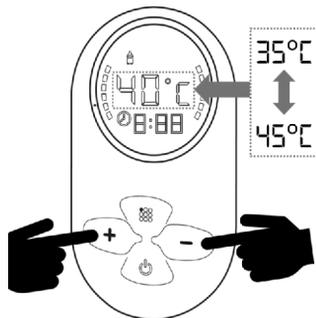
7. Dans les 5 secondes après avoir sélectionné la fonction chauffe biberon, vous pouvez changer la température de 40°C réglée par défauts en appuyant sur le bouton « + » ou « - ». Vous pouvez ainsi sélectionner une température désirée entre 35°C et 45°C.
