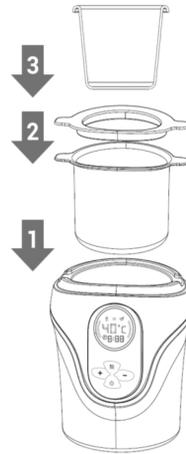
2. Placez le panier repose biberon à l'intérieur de l'appareil, placez l'anneau d'adaptation sur le panier repose biberon et placez un petit bol (non fourni) dans le panier repose biberon.
