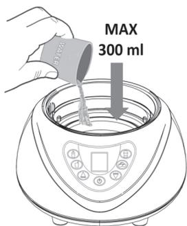
1. Placez la base de l'appareil sur une surface stable, horizontale et plane. A l'aide d'un gobelet doseur (fourni), remplissez le réservoir d'eau avec 150 ml d'eau distillée.
