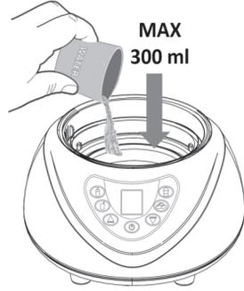
1. ضَع قاعدة الجهاز على سطح ثابت وأفقي ومستوي. باستخدام كوب قياس (مرفق)، املا خزان المياه بـ150 مل من الماء المقطر.
