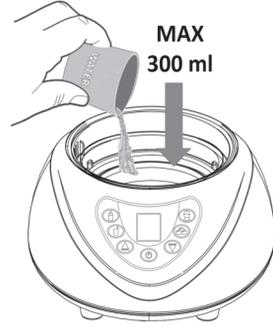
1. ضَع قاعدة الجهاز على سطح ثابت وأقبي ومستوي. باستخدام كوب قياس (مرفق)، املا خزان المياه بـ 200 مل من الماء المقطر.
