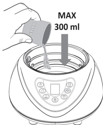
1. Placez la base de l'appareil sur une surface stable, horizontale et plane. A l'aide d'un gobelet doseur (fourni), remplissez le réservoir d'eau avec 200 ml d'eau distillée.
