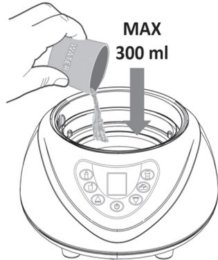
1. ضَع قاعدة الجهاز على سطح ثابت وأقفي ومستوي. باستخدام كوب قياس (مرفق)، املا خزان المياه بـ 200 مل من الماء المقطر.
